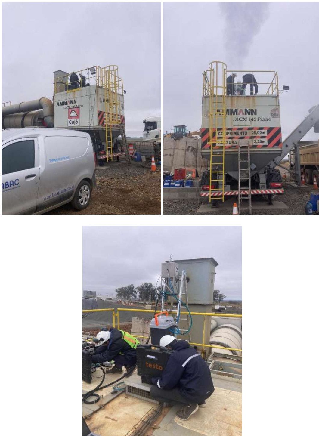
Imagen N°6, 7 y 8: Mediciones de emisiones en Chimenea de la planta asfáltica realizadas el 06/08/2025.
